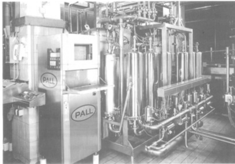
Abb. 1: Automatisches Pall Tandem System mit Vor- und Sterilfilter. Installiert z.B.
